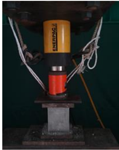
Gambar 1. Uji tekan bata ringan
